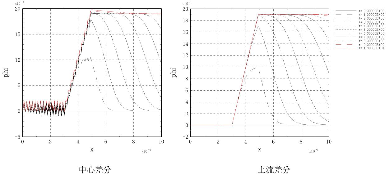
二つ目の問題は積分量の誤差である。元の支配方程式は保存則を表わしているわけだから、計算によって得られた数値解も完全に保存していることが望ましい。ところが差分法では格子点だけに着目した式を取り扱うため、当初の値が完全には保存していないことがある。この問題を解決するためにGDES上で次節に示す方法でコントロールボリューム法<sup>1</sup>を模擬する。
